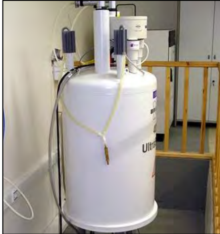
Fot. 23. Equipo de RMN modelo Broker Avance 400 de los laboratorios oficiales de La Grajera donde se realizaron los análisis de calidad del aceite.
