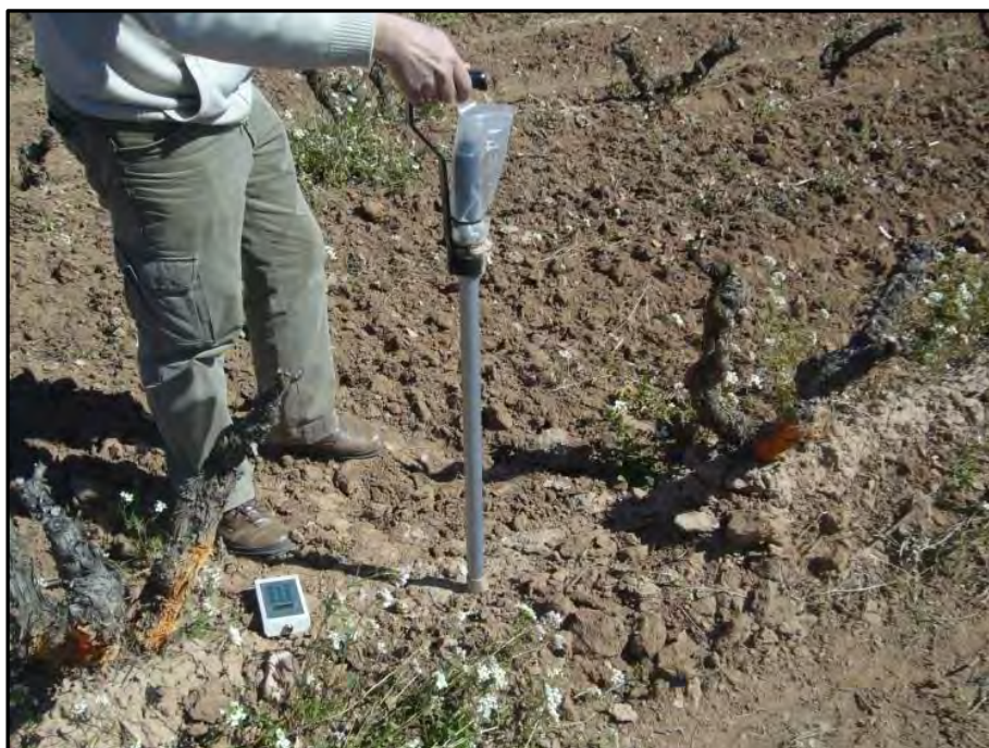
Fot. 5. Sonda FDR para mediciones puntuales a través de un tubo de acceso.
