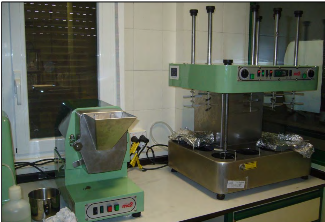
Fot. 22. Extractor Abencor donde se procesaron las muestras (Laboratorios oficiales de La Grajera, en Logroño (La Rioja))
