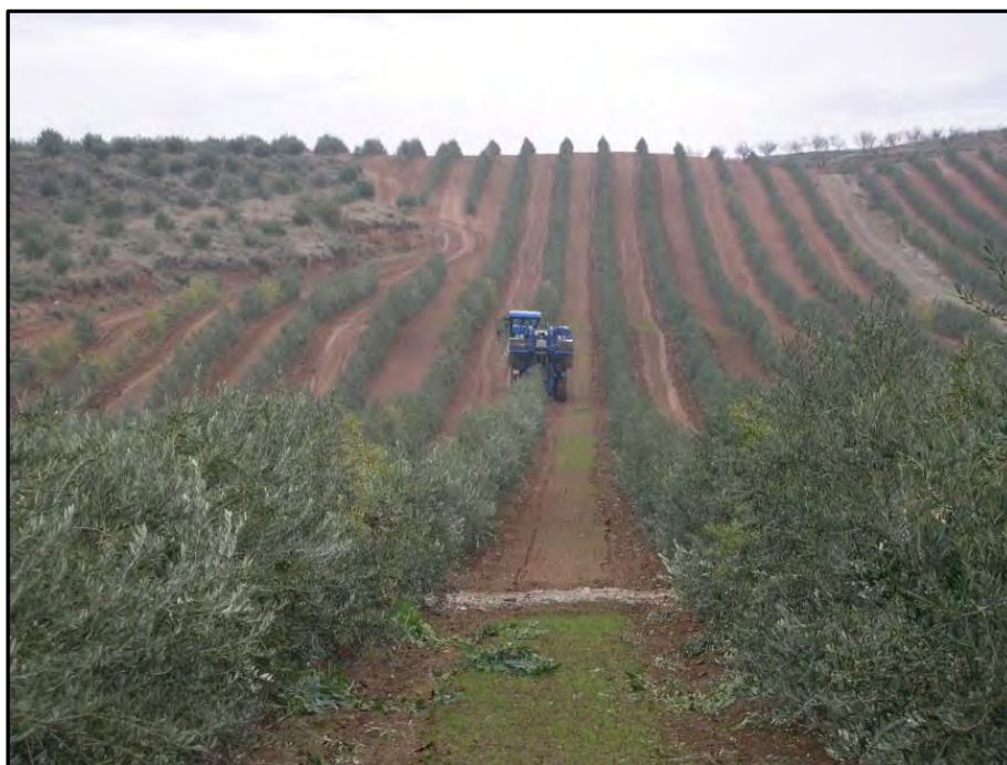
Fot. 3. Recolección mediante máquinas autopropulsadas cabalgantes en una explotación de olivos en cultivo superintensivo de La Rioja.
