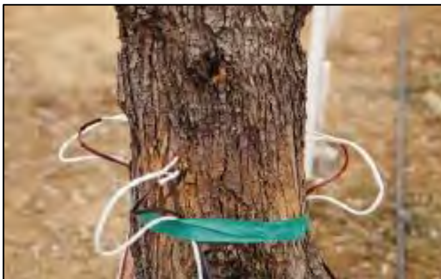
Fot. 8. Instalación de sensor para la medida del flujo de savia
