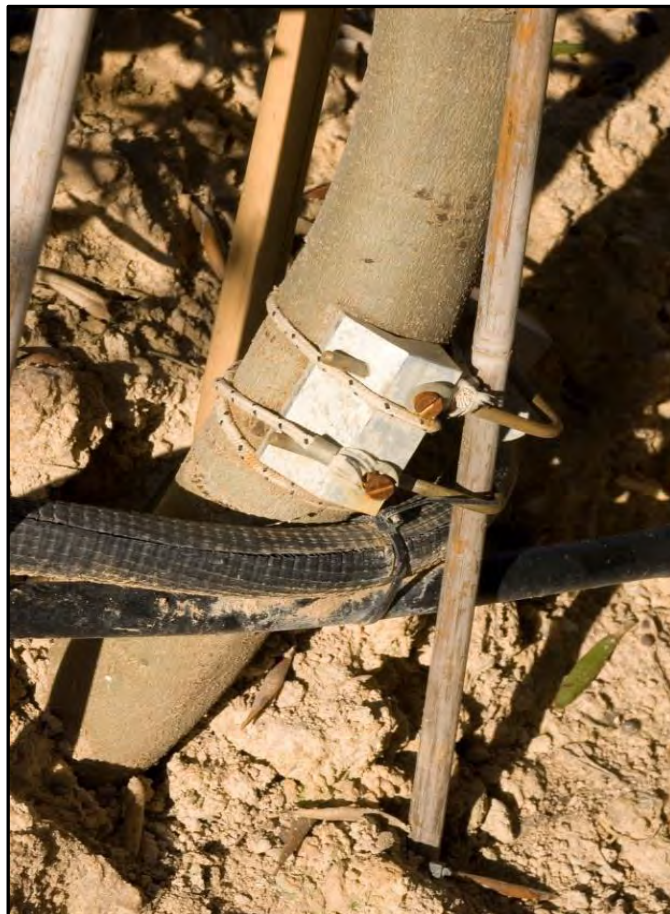
Fot. 6. Dendrómetro instalado en el tronco de un olivo adulto.
