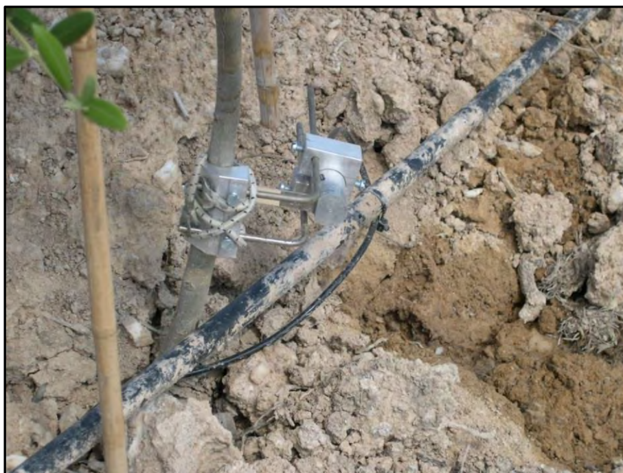
Fot. 7. Instalación de un dendrómetro en un olivo joven
