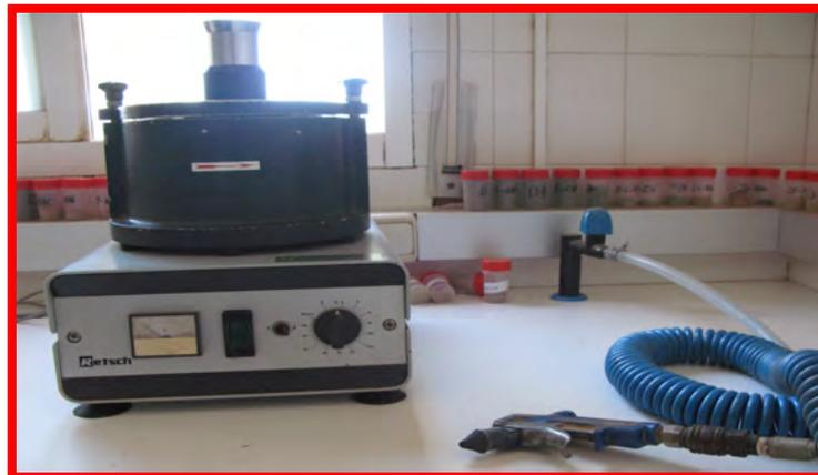
**Figura III.34.** Molino ultracentrífugo y pistola de aire comprimido para su correcta limpieza entre muestra y muestra.
