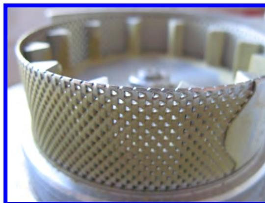
**Figura III.35.** Detalle del tamiz anular de 0,5 mm de luz de malla tras procesar una muestra.
