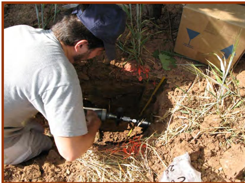
**Figura III.18.** Muestreo de suelo realizado para determinar la densidad aparente, introduciendo un anillo en una de las paredes de la calicata.
