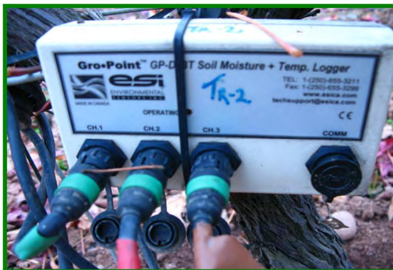
**Figura III.15.** Fotografía de un “datalogger” que registraba los datos de humedad del suelo recogidos por los tres sensores colocados en cada repetición (a 30, 60 y 100 cm de profundidad).
