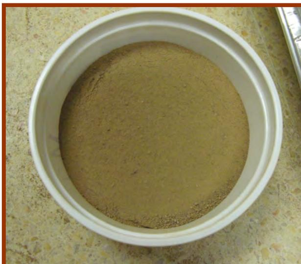
**Figura III.22.** Detalle del tamaño de partícula (diámetro de partícula  $< 2$  mm) de una muestra de suelo ya procesada, lista para su determinación analítica.
