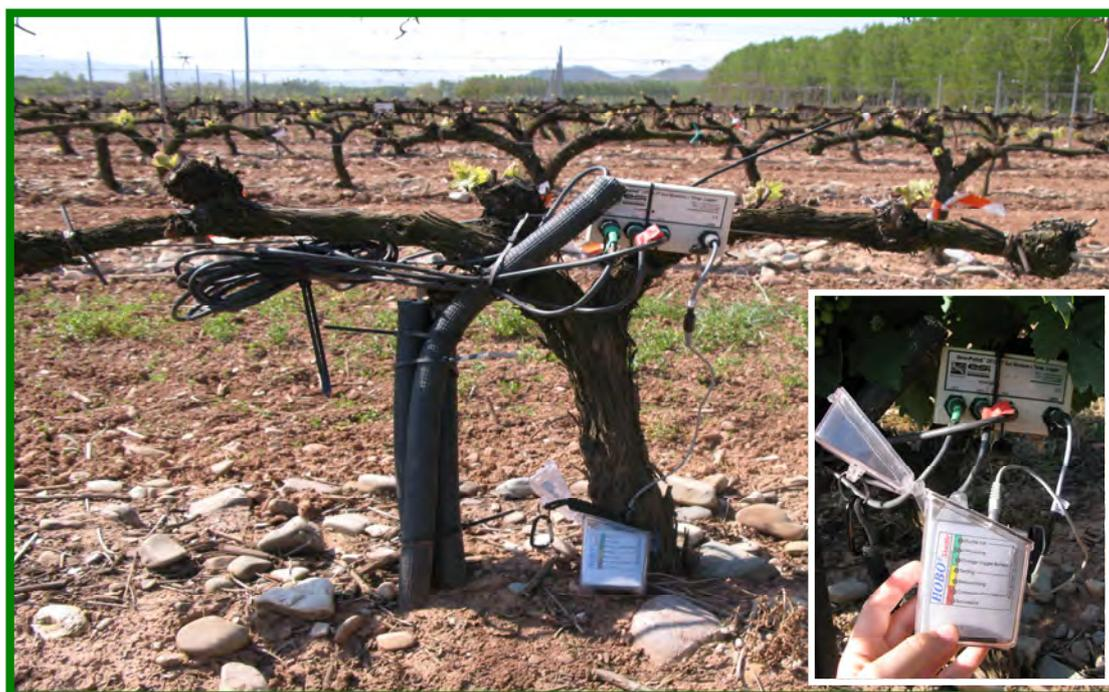
Figura III.16. Detalle del momento de la descarga de los datos registrados en el suelo al “shuttle”.
