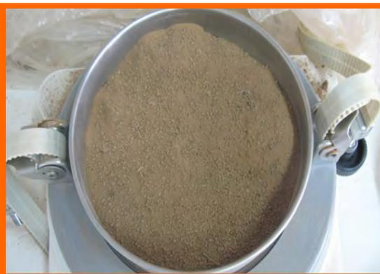
**Figura III.29.** A) Tamizadora que permitió separar las fracciones de suelo con distintos tamaños de partícula. B) Partículas de diámetro mayor de 2 mm, C) Partículas de diámetro menor de 2 mm.
