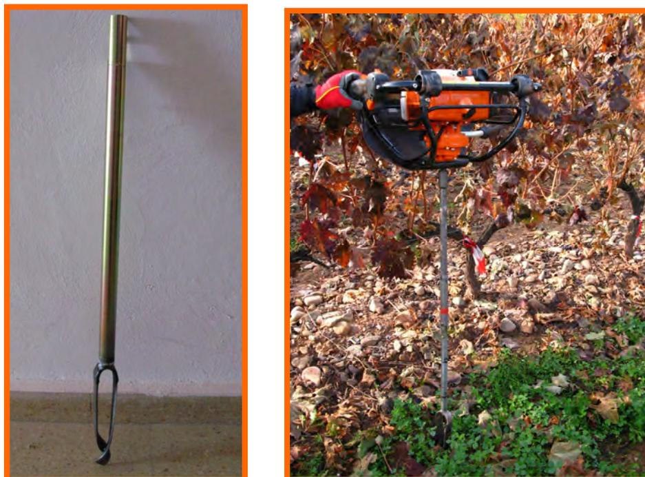
**Figura III.27.** Barrena helicoidal (izquierda) acoplada a la ahoyadora empleada para el muestreo del suelo (derecha).
