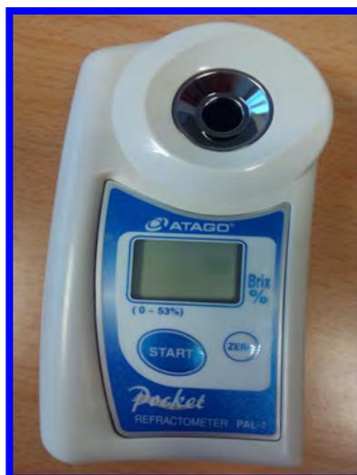
**Figura III.41.** Refractómetro digital portátil.
