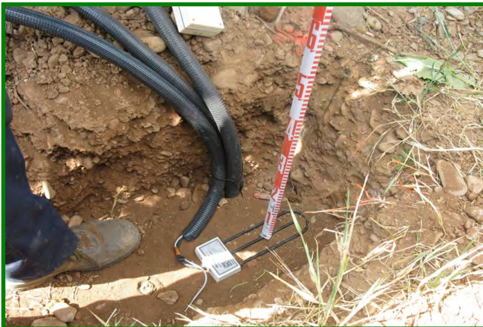
**Figura III.12.** Instalación, a 60 cm de profundidad, de uno de los sensores de humedad del suelo.
