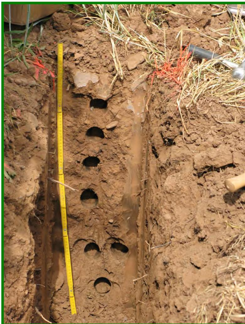
**Figura III.19.** Detalle de la pared de una calicata tras la toma de muestras para la determinación de la densidad aparente del suelo.
