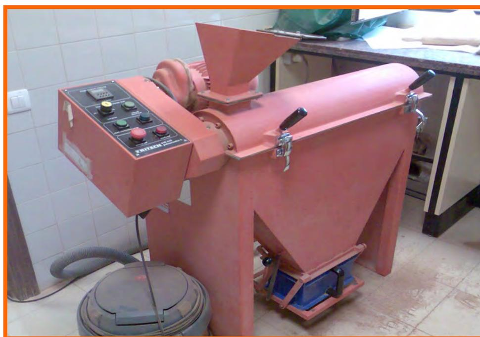
**Figura III.21.** Tamizadora-molino de las muestras de suelo (diámetro de partícula < 2 mm).
