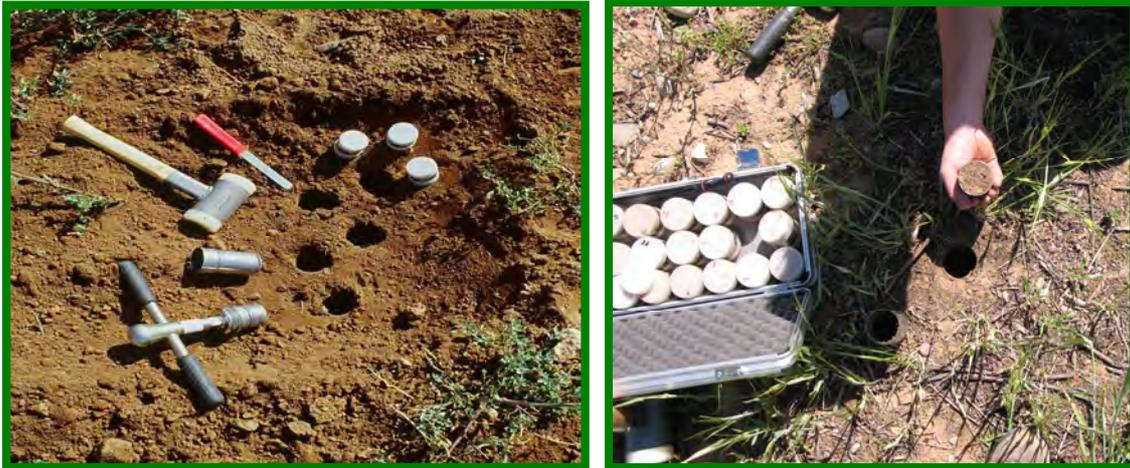
**Figura III.17.** Anillos y herramientas utilizados para coger muestra de suelo con la que poder determinar su densidad aparente.
