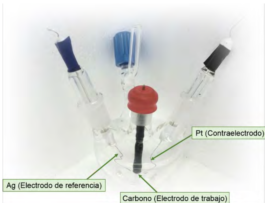
Figura 2.29. Celda electrolítica en donde se llevaron a cabo las voltamperometrías.
