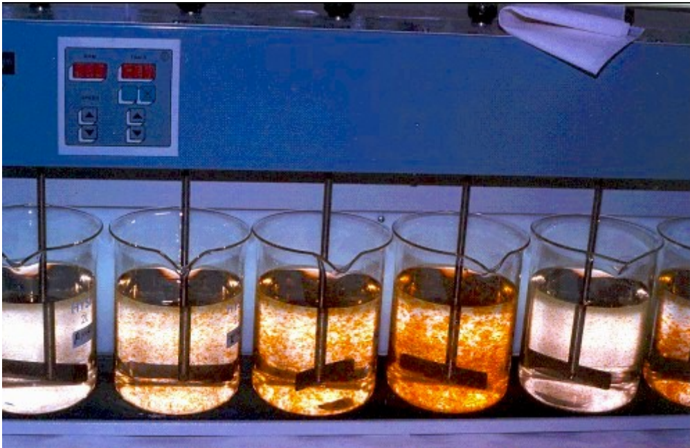
Figura III.2.2a. Ensayos de coagulación-floculación utilizando coagulantes en base hierro y en base aluminio.
