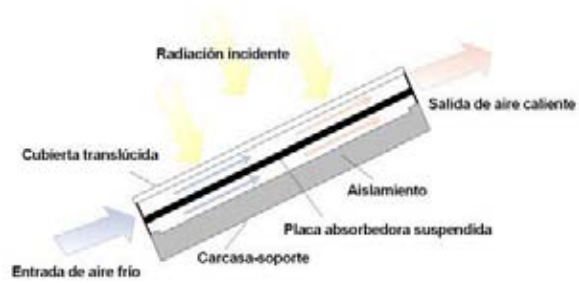
Figura 3.16: Captador solar de aire de placa plana suspendida de simple paso.
