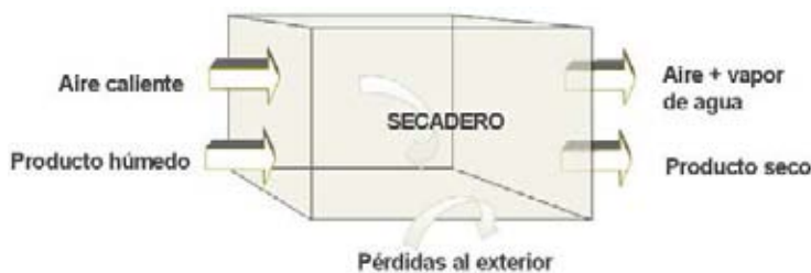
Figura 8.4: Esquema de un proceso genérico de secado.
