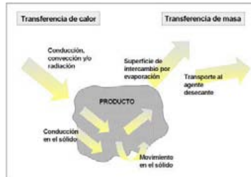
Figura 3.1: Transferencia de calor y masa en el secado.
