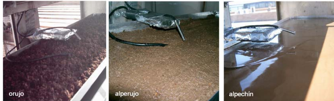
Figura 4.12: Ensayos experimentales para obtener los coeficientes convectivos en los subproductos.
