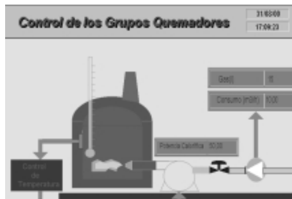
Figura 27: Simulación de proceso industrial con SCADA
