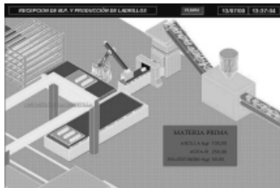
Figura 4: Monitorización con SCADA de zona de planta industrial
